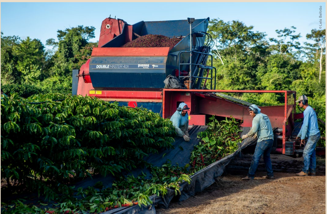
Eine Maschine zieht die abgeernteten Zweige der Kaffeepflanzen ein, zerstückelt sie und separiert die Kaffeebohnen. Die Arbeiter sind einer akuten Unfallgefahr ausgesetzt, weil der nötige Sicherheitsabstand zur Erntemaschine nicht eingehalten wird.
